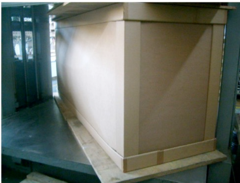
Bild 2. Einknicken von Seitenwänden des Verpackungsproduktes
