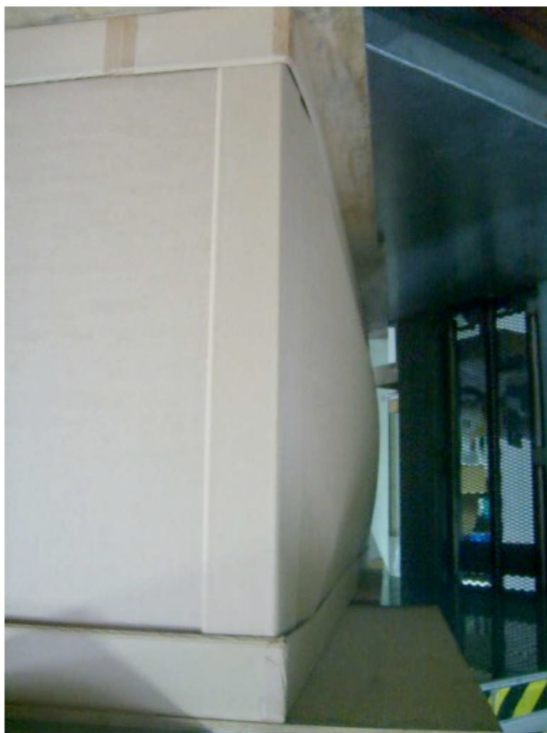
Bild 6. Einknicken von Seitenwänden des Verpackungsproduktes
